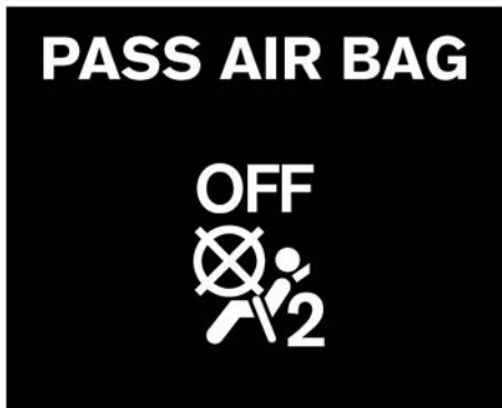
ไฟสถานะถูกลงเสริมความปลอดภัยด้านหน้าฝั่งผู้โดยสาร
